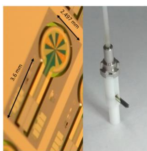
図 6-16 光ファイバー自己整合型 TES 素子
