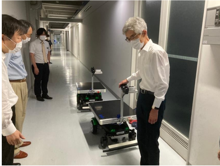
LiDAR を搭載した追従ロボットのデモンストレーション
