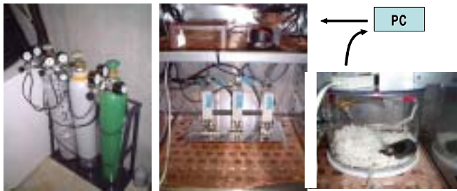
図2 . マウス睡眠時低酸素、高CO2投与装置
