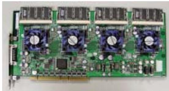
図3. ホログラフィ専用計算ボード
