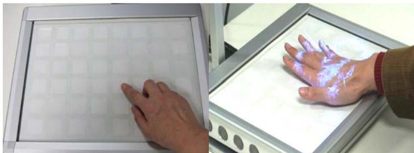
冷温感ディスプレイ性能実験として、ペルチェ素子の反応実験、耐久テスト、複数のペルチェの位置による温度関係などの実験を行った。
