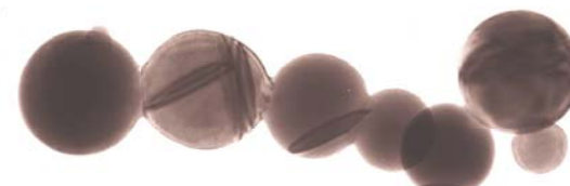
図4 金ナノネットワーク、金ナノ球のSEM像。下図は、金ナノネットワーク構成しているネックレス構造のTEM像
