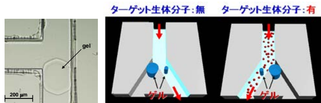
図 5 光重合によって合成した分子応答性ゲルとそのマイクロ流路制御機能のモデル図
