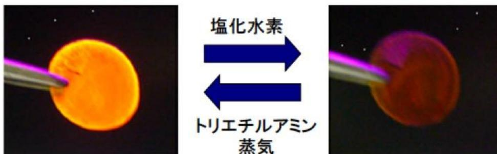
図 3-98 ユウロピウムイオンを含む有機/金属ハイブリッドポリマーにおけるベイポルミネセンス<sup>122</sup>
