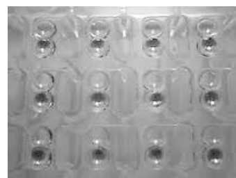
図 2 作製した結晶化プレート。シッティングドロップ結晶化容器に金ナノ構造を構築してある。このウェルにドロップされた溶液から結晶が出現しやすくなる。
