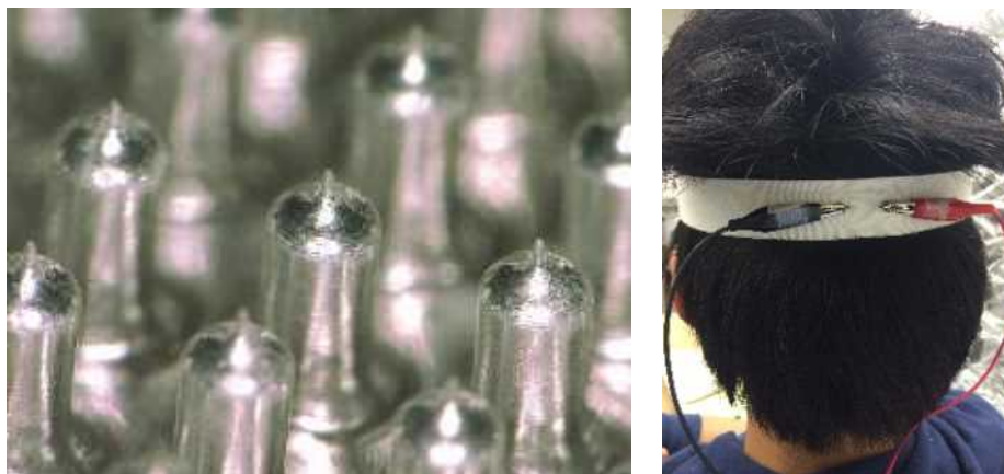
図 10. キャンドル型脳波電極。円柱形状部（0.6 mm 径）により髪の毛を避け、針電極部が角質を貫き、高品質な脳波を計測する。後頭部からの脳波計測に成功した。
