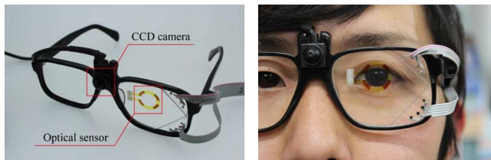
図 5. 色素増感素子を眼鏡レンズ上にパターンニングした透過式ウェアラブル視線検出システム。超低消費電力かつ軽量である。
