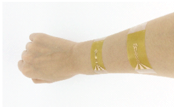
図 11. ウェアラブル電気式触覚ディスプレイ。フレキシブル基板上に針電極を形成することにより、皮膚に貼り付けられる薄さとフレキシビリティを有する。
