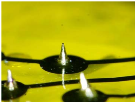
図 11. ウェアラブル電気式触覚ディスプレイ。フレキシブル基板上に針電極を形成することにより、皮膚に貼り付けられる薄さとフレキシビリティを有する。
