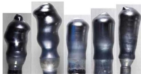
図5. 育成結晶形状の回転楕円鏡水平位置依存性 原料断面:  $20 \times 20 \text{ mm}^2$ , 結晶径: 30 mm, 原料供給速度: 10 mm/h, 結晶育成速度: 5 mm/h, 傾斜角度: 0 deg.
