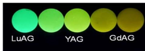
図 3 : LuAG, YAG, GdAG 固溶体セラミックスの写真。
