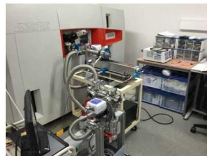
図5. 電圧印加型真空対応 4 軸マニピュレーター、グローブボックスで調製した環境セルを大気非暴露で XPS と連結、充放電時の電極反応をその場観察可能.
