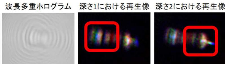
図 6. 波長多重インコヒーレントホログラムセンシング実験結果. 被写体は 6 mm × 3 mm の抵抗器. 赤矩形は合焦部. 光源は中心波長 455 nm, 530 nm, 625 nm の LED.
