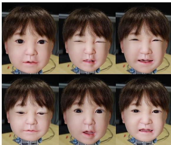
図 子供アンドロイド Affetto の新型頭部の表情の例
