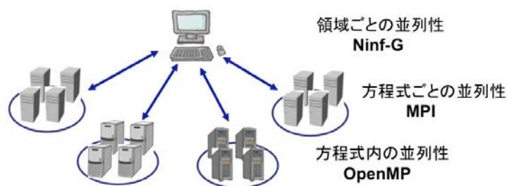
図 3.2-②-1 Ninf-G/MPI/OpenMP ハイブリッドによる並列化
