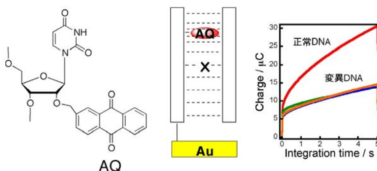
Fig. 4.3.3 アントラキノン(AQ)修飾 DNA 固定化チップとそれを利用した DNA 一塩基変異の電気化学検出
