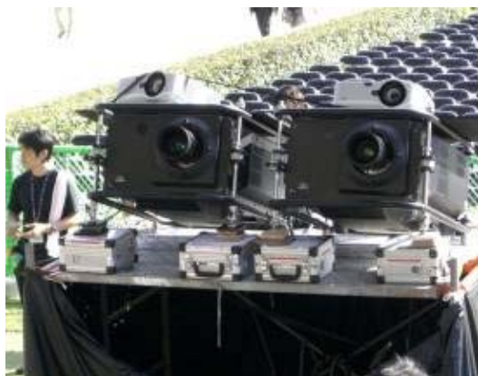
下段には照明との干渉を考慮し 12,000 ルーメンの高輝度プロジェクター 2 台をスタックして投影を行った。
