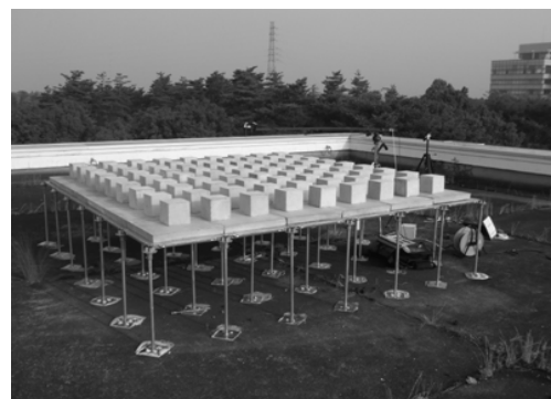
図 4.4.10 建築研究所実験棟屋上に設置したスケールモデル(つくば)
