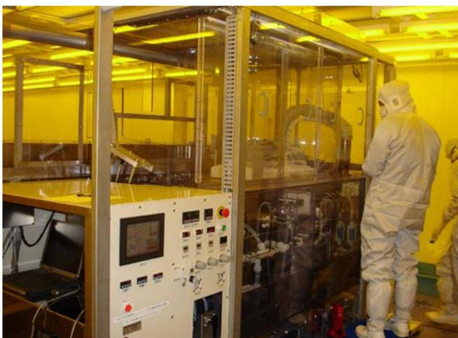
図 17 TFT 用硝酸酸化装置
