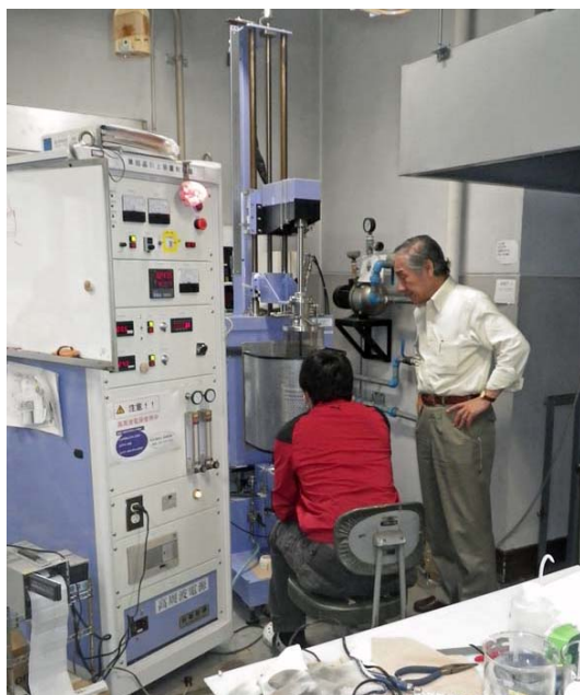
REInO 3 および LaBGeO 5 単結晶育成に用いた高周波誘導加熱引き上げ炉と、結晶育成中の宮澤教授と学生
