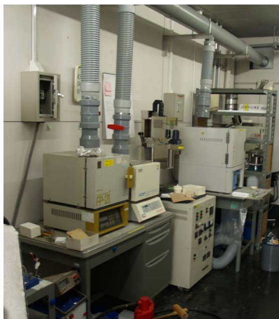
FeSi 2 結晶育成炉および結晶育成用母原料焼結炉
