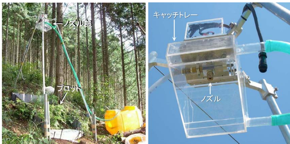
図 3.5-1 振動ノズル式散水装置 左：実験プロット概況，右：ノズル部拡大写真．
