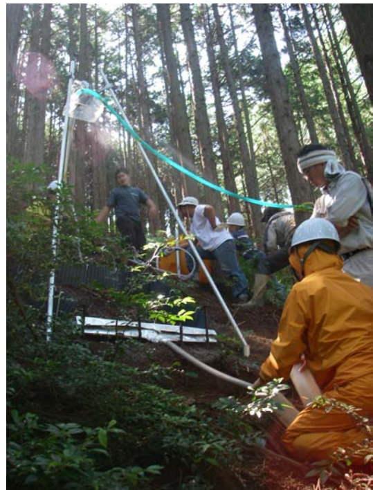
図 8-3 振動ノズル式散水装置による現地浸透能試験の様子(三重サイト)。それぞれが役割分担しながら、表面流出水を 1 分ごと計測する。
