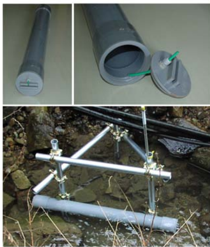
図 3.3-12 （上）浮遊土砂サンプラーの採取口の構造と（下）河床に設置したサンプラー
