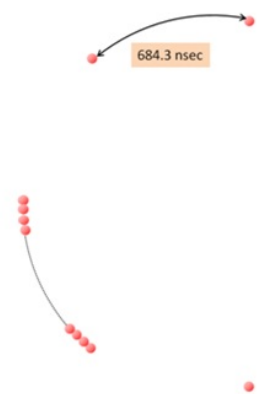
図1 SPring-8の蓄積リングにおける電子の分布(バンチモード)。電子はバンチと呼ばれる単位に分離して蓄えられた状態で蓄積リングを周回している。電子の総量は蓄積電流が100mAとなるように調節されている。この図は2010A/2011A期のDモードで、蓄積リングの1/7周に電子が等間隔に詰め込まれており、それ以外では5つの孤立バンチ(50ピコ秒程度)となっている。孤立バンチには各3mAの電流が蓄えられており、85mAが連続部分に蓄えられている。
