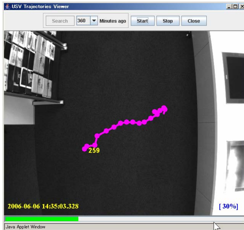
図14. 移動軌跡データ検索システムのスナップショット USV の軌跡情報の取得機能を使用し、原画像を保持せずに、 軌跡データだけを SENSORD に蓄積することが可能.
