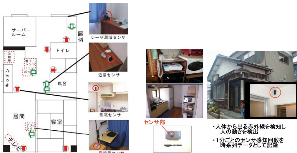
図 4-1-2 生活データ蓄積と異常検知の基礎実証実験マンションおよびデータ提供協力家庭の例
