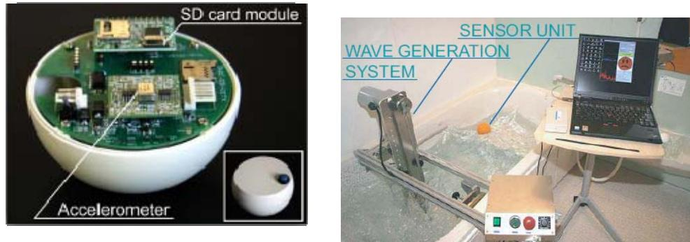
図12:加速度センサを用いた浴室室内乳幼児溺れ防止システム(左)とその検証システム(右)
