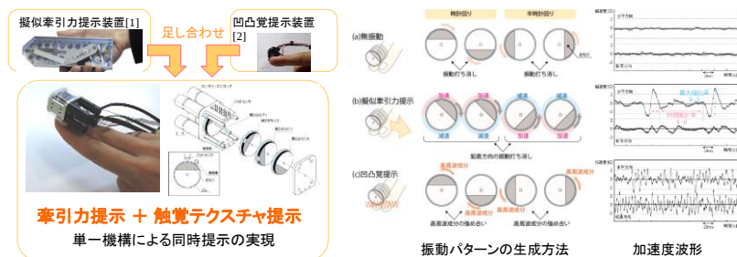
図 阪大-7 牽引力／凹凸感を提示する爪装着型触覚提示デバイス
