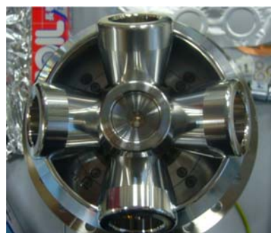
図 23 (上)ミニモット検出器の概観(立体図)と(下)電子偏向器側から見た写真
