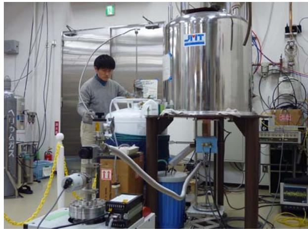
博士研究員の野田が検出系冷却装置(クライオコイル MAS プローブ)で測定している様子
