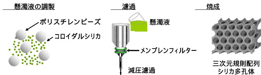
図 19 減圧濾過法を用いた三次元規則配列シリカ多孔体の作製。
