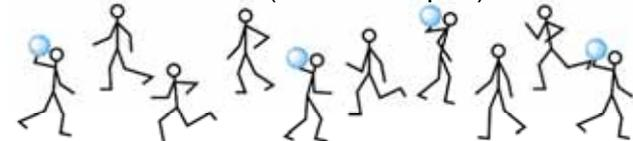
図 26 プロトン伝導機構の模式図。Grotthuss (プロトンホッピング) 機構と Vehicle (物質輸送) 機構。
