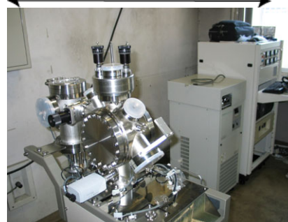
図 1-2 . (上) モジュールシステム概念図。標準化された3～5個のチャンバーを集積化 (下) 実際に作製したμPLDユニット。
