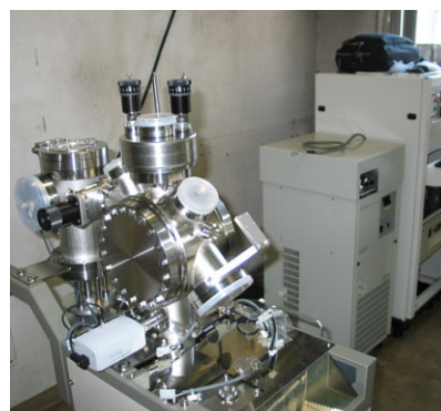
図 3-1-8(右)モジュールユニットの基本構造図。(左)実際に作製したパルスレーザー薄膜堆積モジュール。
