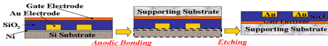
図 3-5-14 貼り合わせ法による平坦化ナノ電極作製プロセスの概念図。
