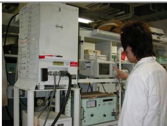
擬似太陽光源(Solar Simulator):擬似太陽光照射下における複合電極の光電流－電位特性の測定ならびに太陽エネルギー変換効率の決定に使用
