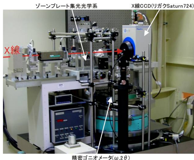
図 17 微小結晶構造解析用に最適化されたピンポイント構造計測装置の写真。
