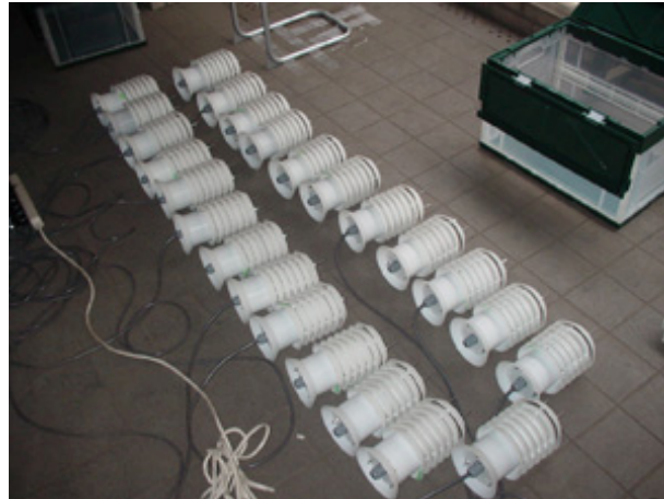
写真 7. 微気象センサネットワーク TScan システム(2009 年 5 月)
