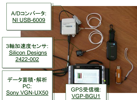
図1 振動計測システムプロトタイプ「Model I」
