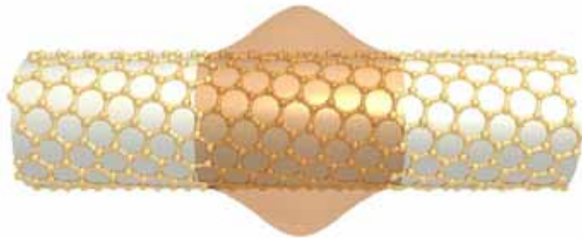
図1：(10,5)の半導体ナノチューブの励起子の波動関数の概念図。電子とホールがクーロン力で結合し、空間的に局在（オレンジ色）する。
