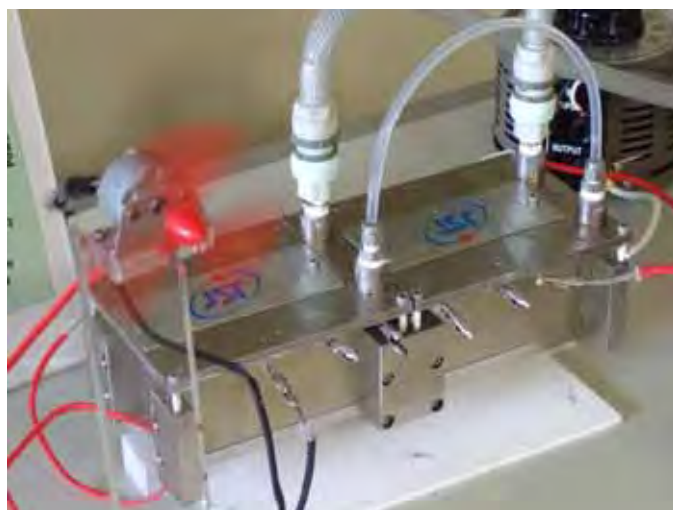
図 9 熱電酸化物モジュールによる発電デモンストレーション
