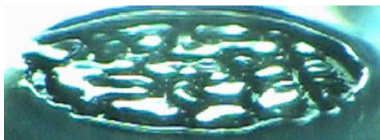
図 27 粘着剤のプローブタック実験の結果
