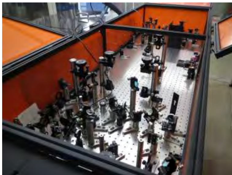
100 kHz で動作する非同軸型光パラメトリック増幅器
