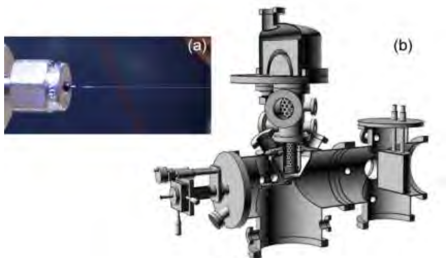
図 26 (a) 内径 25 \mu\text{m} の熔融石英キャピラリーから吐出された液体層流、(b) 多段階差動排気によって検出器の真空度を維持した液体用半球型光電子エネルギー分析装置
