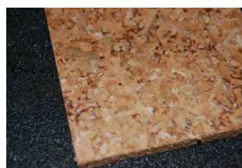
図 32. 樹皮プラスチック複合材.
