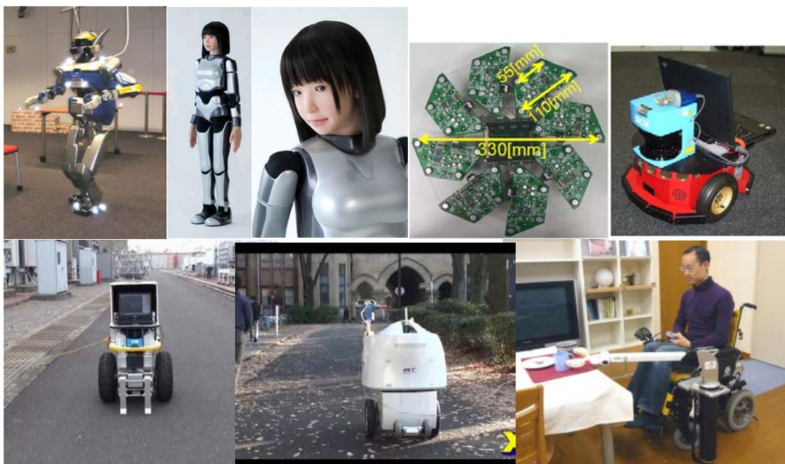
図 5 内部ユーザーグループのロボットアプリへの実装例（上段左から、ヒューマノイドロボット HRP2, HRP4-c, 全方位望遠マイクロフォンアレイ、車輪移動ロボット Pioneer、下段左から Segway、PMR、上肢に障害のある人用小型軽量ロボットアーム Rapuda）
