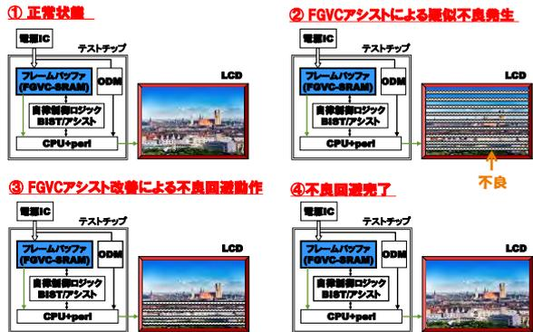
① 正常状態 ② FGVCアシストによる類似不良発生 ③ FGVCアシスト改修による不良回避動作 ④ 不良回避完了 図 4-5-8 デモデモンストレーション環境
