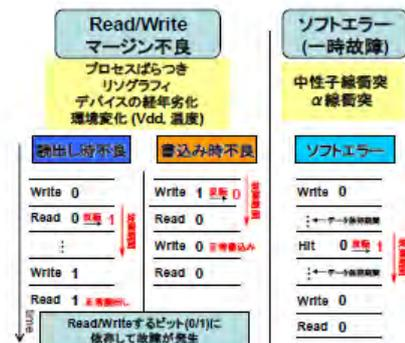
図 4-6-4 メモリ不良のモデル化
