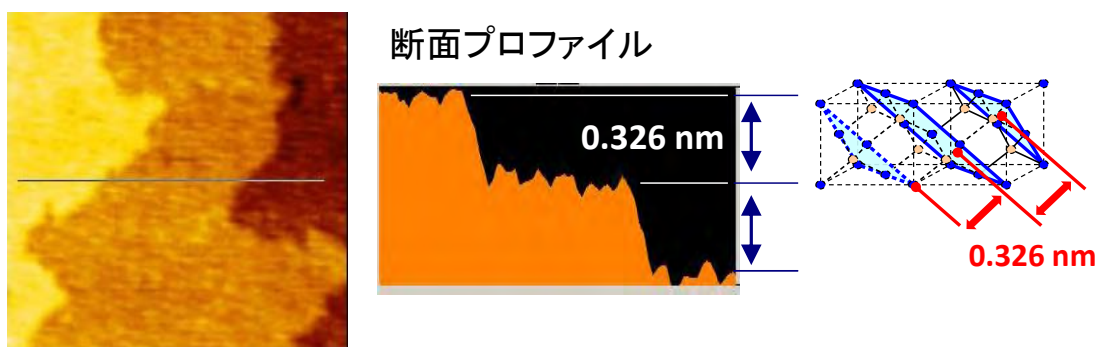
図 3-6 Ge(111)表面の水素アニール後の AFM 像 (700°C, 10 分)。(a) 0.7μm×0.7μm 領域における表面 AFM 像。(b) (a)図の線上における断面ステップ像。右に模式的に(111)面におけるステップを示している。~0.32nm のステップはまさに(111)面のステップを示す。
