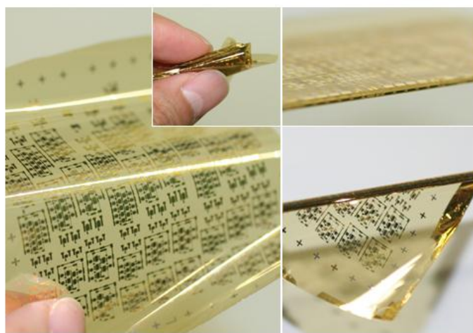
図 1-1: 機械的特性と電気的特性を兼ね備えた有機トランジスタ集積回路。
