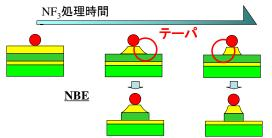
図8 NF3 処理時間制御によるナノディスク直径制御の模式図
