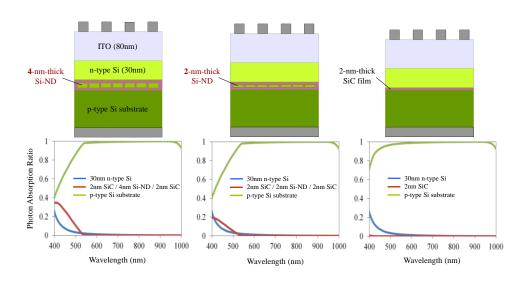
図 32 太陽電池構造における各層の光吸収率
