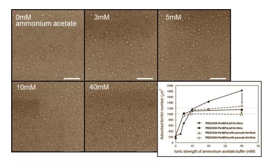
図6 0.05 mg/mL 分子量 2000 o PEG で就職したフェリチンを使ったフェリチン分散配置 の SEM 像。PEGylated フェリチンはそれぞれ純水中、3mM 酢酸アンモニウム、5 mM 酢酸アンモニウム、5 mM 酢酸アンモニウム、10 mM 酢酸アンモニウム、40 mM 酢酸アンモニウムにあらかじめ分散したものを使用した。PEG2000 分子では 10mM 以上の濃度で Debye 長が PEG 層より短くなることが分かる。
