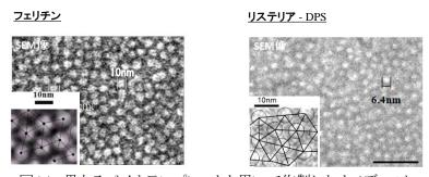
図11 異なるバイオテンプレートを用いて作製したナノディスク
