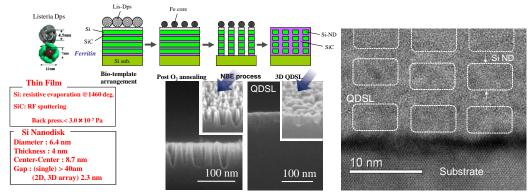
図 33 積層 Si ナノディスク作製プロセスと作製結果
