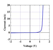
図 42 InGaAs/GaAs 量子ナノディスクアレイにおける電流注入よる発光特性
