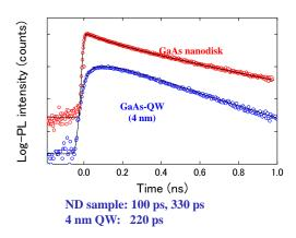
図 27 作製した GaAs ナノディスクアレイにおけるピコ秒時間分解発光分光
