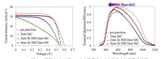
図 31 単層 Si ナノディスク太陽電池の I-V 特性と外部量子効率
