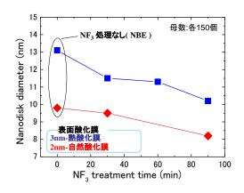
図9 NF3 処理時間によるナノディスク直径制御
