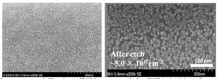
図 14 Si-NBO を用いた Ge 基板上へのフェリチン配置およびナノディスク
