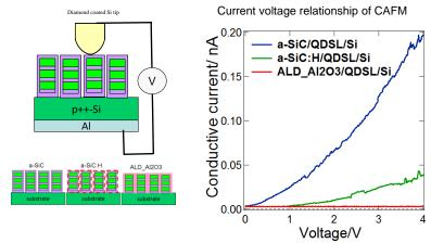
図 37 積層 Si ナノディスクのリーク電流
