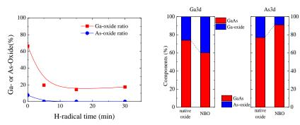
図 17 水素ラジカル処理による酸化膜除去(左)と、 水素ラジカル処理前の表面の状態(右)
