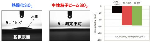
図3 熱酸化膜とNBO酸化膜の親水性(接触角)およびゼータ電位
