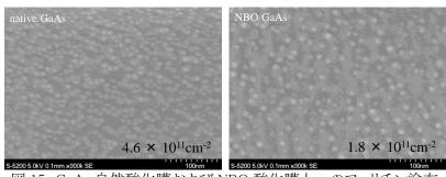
図 15 GaAs 自然酸化膜および NBO 酸化膜上へのフェリチン塗布
