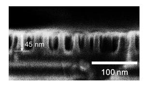
図 43 バイオテンプレートと中性量子ビームエッチングを組み合わせた極限加工技術を用いて作製した InGaN/GaNナノ構造の SEM 観察画像
