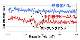
図2 熱酸化膜と中性粒子ビーム酸化膜の ESR 測定結果
