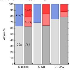
図 16 各種方法によるタンパク質除去処理後の基板表面の XPS 分析結果
