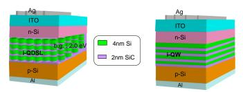
図 34 積層 Si ナノディスクを用いた太陽電池の構造
