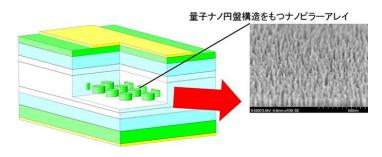
図 40 作製した GaAs/AlGaAs ナノピラー構造
