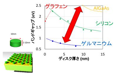
図 20 各種ナノディスク構造における膜厚制御によるバンドギャップ制御
