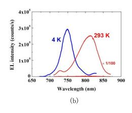
図 41GaAs/A1GaAs 量子ナノディスクアレイにおける電流注入よる発光特性
