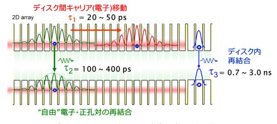
図 21 ナノディスク 2 次元アレイ中における高速トンネル電子移動
