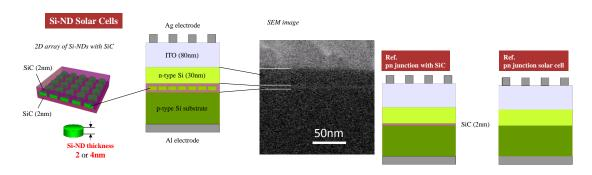
図 30 単層 Si ナノディスク太陽電池と比較のためのサンプルの構造
