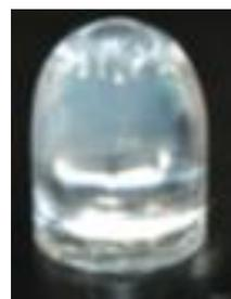
図 16. CNF ゲル/ポリマー複合材料の外観写真
