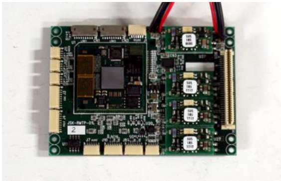
図 47: 30mm 角 D-RMTP I SiP 搭載制御基板
