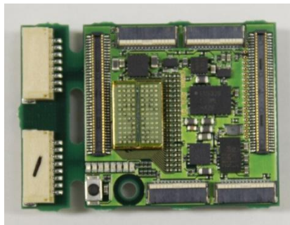
図 9: DRAM 基板 (左: 表面 右: 裏面)
