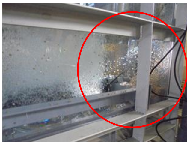
図 7-6 微細気泡装置を使用した場合に観察された担体の偏り
