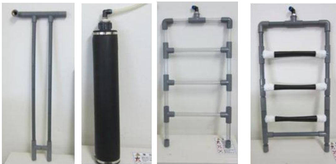
図 7-5 本研究で検討した散気装置 (左から粗大気泡、微細気泡、改良型粗大気泡、改良型微細気泡)
