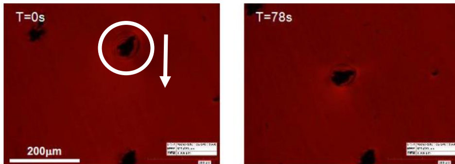
図9 低分子液晶中のアゾベンゼン修飾 GO の光運動挙動
