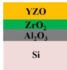
Fig.3-3-3 ZrO 2 /拡散防止層を挿入したパッシベーション構造
