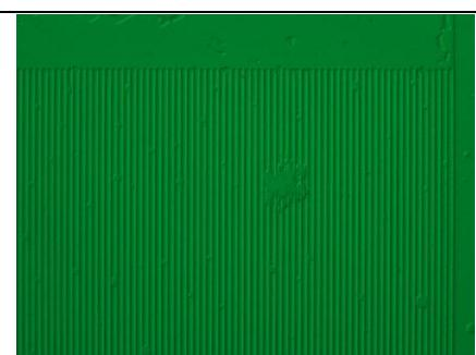
図 9. 405nm 励起用 2 次 QPM 分極反転構造
