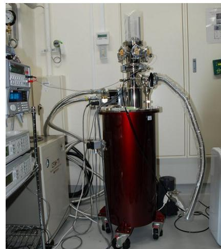
図 2. 開発した超伝導光子検出システム。極低温(4K)クライオスタットチャンバー内部に、ナノ細線超伝導光子検出デバイスを設置している。
