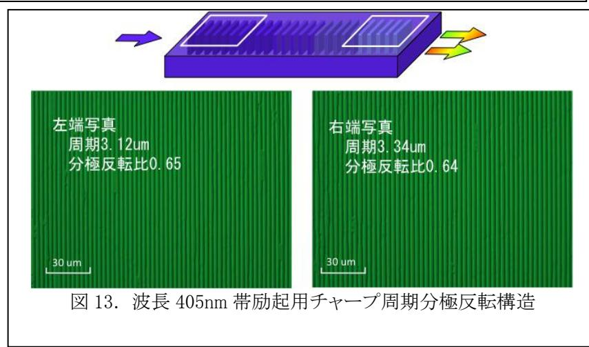
図 13. 波長  $405\text{nm}$  帯励起用チャープ周期分極反転構造
