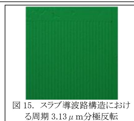
図 15. スラブ導波路構造における周期  $3.13 \mu\text{m}$  分極反転
