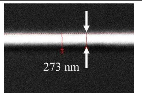
図 4. 光ファイバの一部を延伸して作成したナノ光ファイバの操作型電子顕微鏡像。延伸部直徑は推定 273nm。
