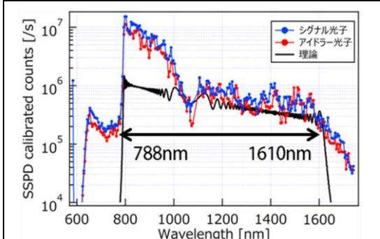
図 1. 超伝導光子検出システムで測定した非同軸発生パラメトリック蛍光対の周波数スペクトル
