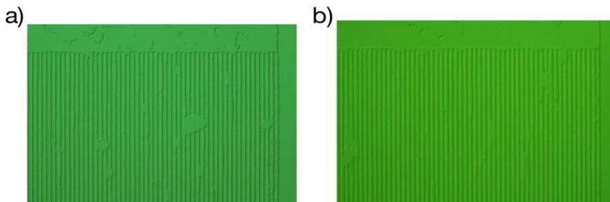
図 12. 周期  $3.13 \mu\text{m}$  分極反転構造におけるマイクロドメイン除去プロセスの効果
