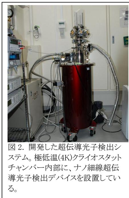
図2. 開発した超伝導光子検出システム。極低温(4K)クライオスタットチャンバー内部に、ナノ細線超伝導光子検出デバイスを設置している。
