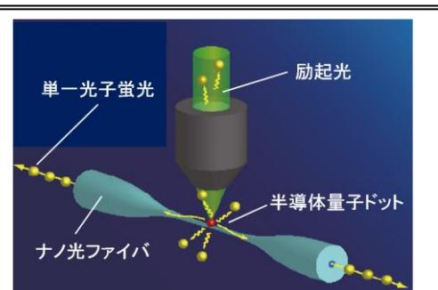
図 5. ナノ光ファイバ表面の半導体量子ドットからの単一光子蛍光の高効率結合
