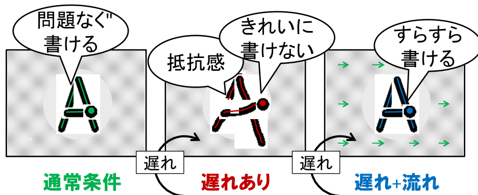
図7: 潜在感覚運動による随意運動のアシストで遅延の影響を低減
